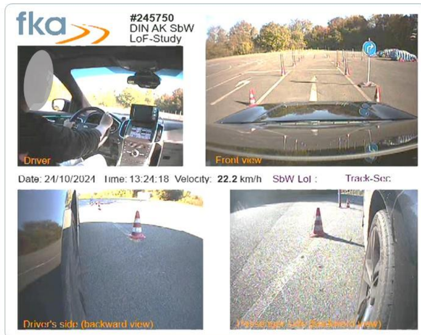
Abb. 3-10: Videodatenerfassung mit vier Kameraperspektiven
