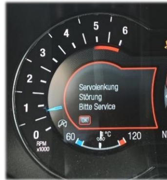
Abb. 3-2: Warnung/Fehlermeldung bei LoF-Fehleraufschaltung im Ford Edge
